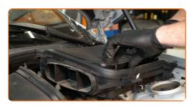
Befestigen Sie die Clips der Innenraumfilterabdeckung.
