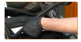
Entfernen Sie das Luftfiltergehäuse.
