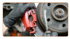
Entfernen Sie den Bremssattel.
