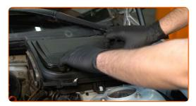
5 Entfernen Sie den Gehäusedeckel des Innenraumfilters.
