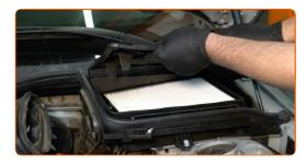
6 Entfernen Sie die Abdichtung des Mikrofilterkastens.
