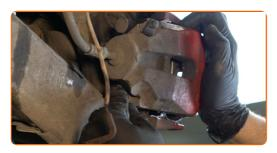
Verbinden Sie den Bremsbelag-Verschleiß-Sensor.
