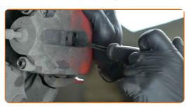
Lösen Sie die Bremssattel-Haltefeder. Benutzen Sie ein Brecheisen.
