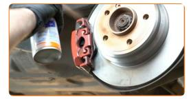
Die Bremsscheibenoberfläche reinigen. Benutzen Sie einen Bremsenreiniger.
