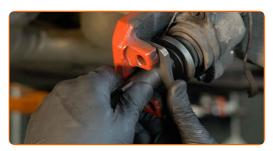
Säubern Sie die Halterung des Bremssattels. Benutzen Sie eine Drahtbürste. Verwenden Sie Allzweckreinigungsspray.
