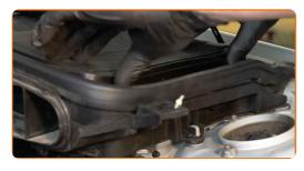
Bringen Sie das Luftkanal-Gehäuse an.
