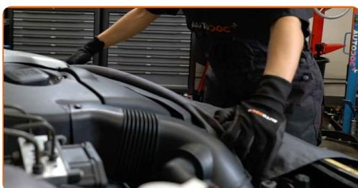
**3** Schrauben Sie das Verbindungsteil der Motorhaube ab. Verwenden Sie Inbusschlüssel Nr. H5. Verwenden Sie einen Ratschenschlüssel.
