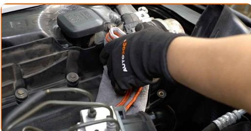
**13** Reinigen Sie die Abdeckung und das Gehäuse des Luftfilters.
