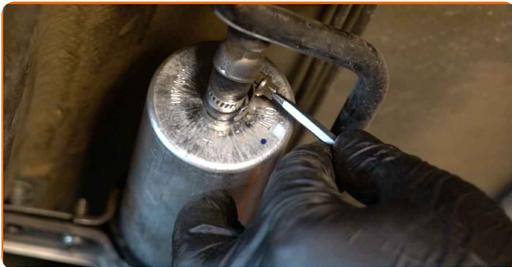
5 Lösen Sie die Halterung des Kraftstofffilters. Verwenden Sie Stecknuss Nr. 10. Verwenden Sie einen Ratschenschlüssel.
