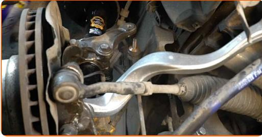
**45** Ziehen Sie die Befestigungselemente des Stabilenkers fest. Verwenden Sie Ring-Gabelschlüssel Nr. 16.
