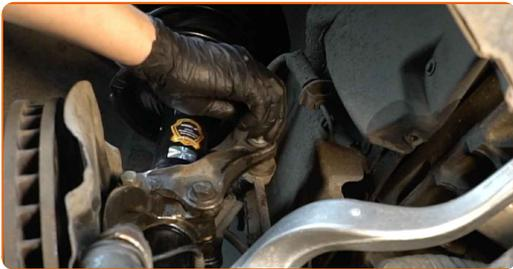
**46** Schließen Sie den Sensor der Leuchtweitenregulierung wieder an.
