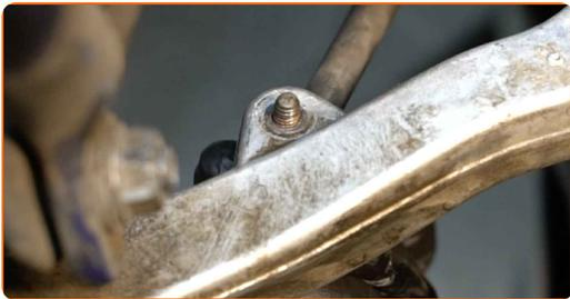
**47** Schrauben Sie die Befestigungen des Sensors der Leuchtweitenregulierung ein. Verwenden Sie Ring-Gabelschlüssel Nr. 9. Verwenden Sie Ring-Gabelschlüssel Nr. 10.
