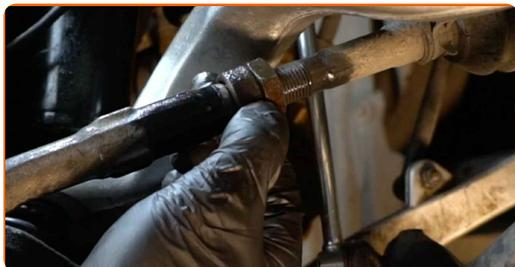
**9** Beim Deinstallieren sollten Sie die genaue Position des Kugelgelenks an der Spurstange markieren oder messen - oder zählen Sie die Anzahl der Windungen, um danach eine Fehlausrichtung zu vermeiden. Verwenden Sie einen Messschieber.
