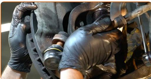
**18** Schrauben Sie die Befestigungsmutter auf, die den Spurstangenkopf mit dem Achsschenkel verbindet. Verwenden Sie Stecknuss Nr. 21. Verwenden Sie einen Ratschenschlüssel.
