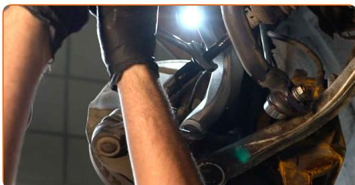
**8** Hebeln Sie den Klemmring vom Spurstangenkopf ab. Benutzen Sie ein Brecheisen. Benutzen Sie einen Hammer.
