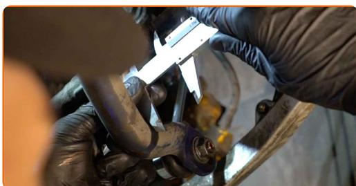
**10** Lösen Sie das Ende der Befestigungsmutter an dem Achsschenkel. Verwenden Sie Stecknuss Nr. 21. Verwenden Sie einen Ratschenschlüssel.
