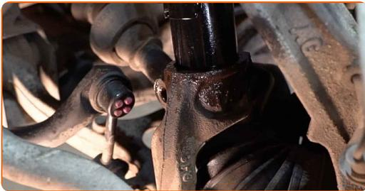
**37** Bringen Sie die Befestigungsschraube an. Verwenden Sie einen Gummi-Hammer.
