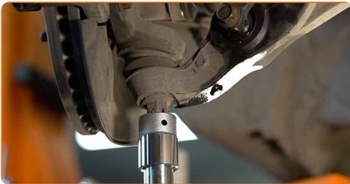
**39** Ziehen Sie die Befestigungsschraube an, die das Federbein mit der Stoßdämpfergabel verbindet. Verwenden Sie Stecknuss Nr. 14. Verwenden Sie einen Drehmomentschlüssel. Ziehen Sie ihn mit 49 Nm Drehmoment fest.
