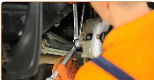
**13** Ziehen Sie das Befestigungselement an, das die Druckstange mit dem Federbein verbindet. Verwenden Sie Stecknuss Nr. 17. Verwenden Sie einen Drehmomentschlüssel. Ziehen Sie ihn mit 40 Nm Drehmoment fest.
