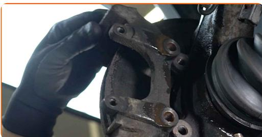
**15** Entfernen Sie die Bremsscheibe.
