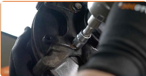
**14** Entfernen Sie die Sattelhalterung.
