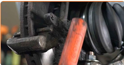
**13** Lösen Sie die Befestigung der Sattelhalterung. Verwenden Sie Stecknuss Nr. 17. Verwenden Sie ein Windeisen.
