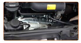
Schrauben Sie die Zündspulenklammer ab. Verwenden Sie Stecknuss Nr. E11. Verwenden Sie einen Ratschenschlüssel.
