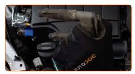
Bauen Sie die neue Zündspule in die Vertiefung der Zündkerze ein. Stellen Sie sicher, dass Sie dabei das Klicken hören, welches entsteht, wenn sich diese in der korrekten Position befindet.
