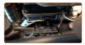
Ziehen Sie die Zündspulen Befestigung an. Verwenden Sie Stecknuss Nr. E11. Verwenden Sie einen Drehmomentschlüssel. Ziehen Sie ihn mit 12 Nm Drehmoment fest.
