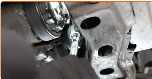
**4** Entfernen Sie den Keilrippenriemen.
