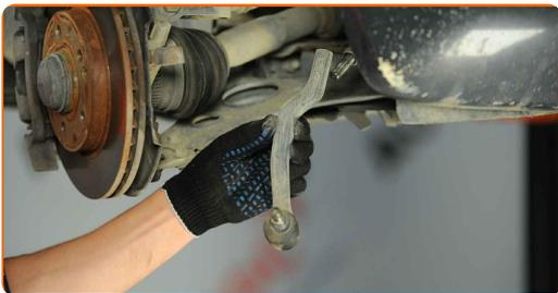
**13** Reinigen Sie die Montagesitze des Spurstangenkopfes. Benutzen Sie eine Drahtbürste. Benutzen Sie WD-40-Spray.
