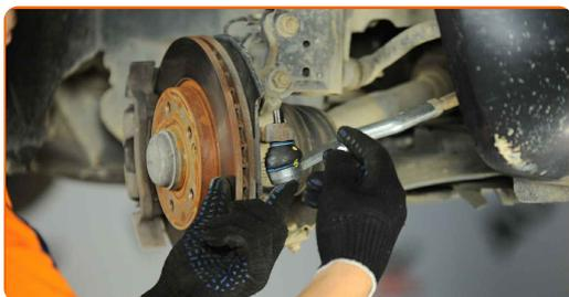
**16** Ziehen Sie die Befestigungsmutter an, die den Spurstangenkopf mit dem Achsschenkel verbindet. Verwenden Sie Stecknuss Nr. 18. Verwenden Sie einen Drehmomentschlüssel. Ziehen Sie ihn mit 30 Nm Drehmoment fest.+90°
