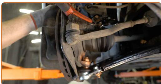
**10** Lösen Sie das Ende der Befestigungsmutter an dem Achsschenkel. Verwenden Sie Stecknuss Nr. 18. Verwenden Sie einen Ratschenschlüssel.
