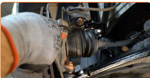
**14** Schrauben Sie einen neuen Spurstangenkopf an.
