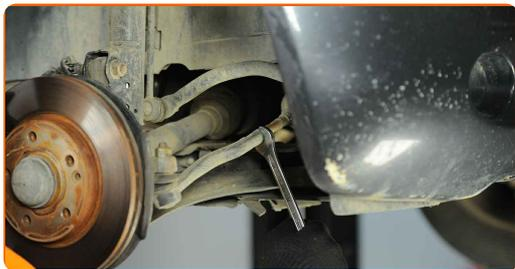
**9** Reinigen Sie das Befestigungselement, das den Spurstangenkopf mit dem Achsschenkel verbindet. Benutzen Sie eine Drahtbürste. Benutzen Sie WD-40-Spray.
