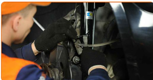
**42** Verbinden Sie den Unterarm mit dem Achsschenkel. Benutzen Sie ein Brecheisen.
