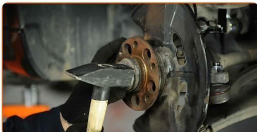
**50** Reinigen Sie die Nabe. Benutzen Sie eine Drahtbürste.
