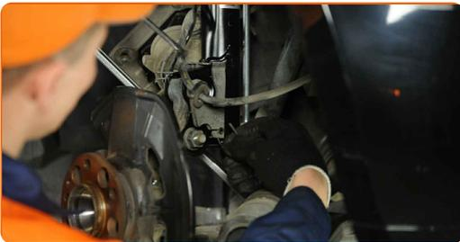
**26** Die Befestigungselemente, die das Federbein mit dem Achsschenkel verbinden, reinigen. Benutzen Sie eine Drahtbürste. Benutzen Sie WD-40-Spray.
