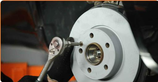
**14** Entfernen Sie die Bremsscheibe.
