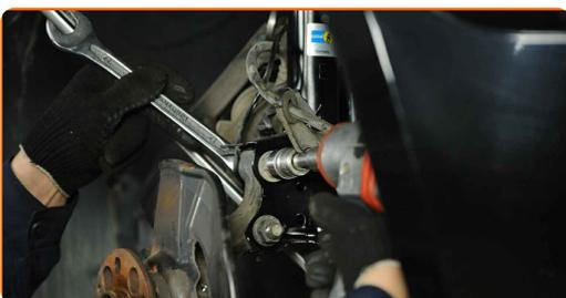
**28** Entfernen Sie die Befestigungsschrauben.
