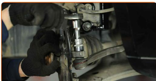
**48** Ziehen Sie die Nabe hindurch. Verwenden Sie Stecknuss Nr. 30. Verwenden Sie einen Drehmomentschlüssel. Ziehen Sie ihn mit 100 Nm Drehmoment fest.+60°
