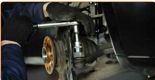
**17** Ziehen Sie den Spurstangenkopf vom Achsschenkel. Verwenden Sie einen Kugelgelenkabzieher.
