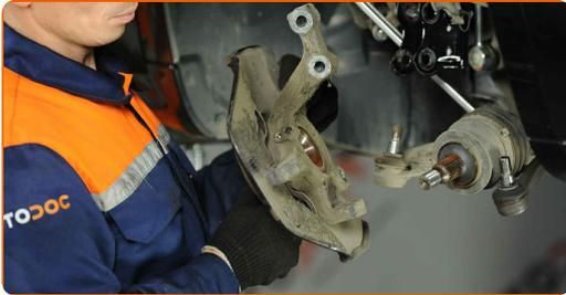
**30** Drücken Sie die Radnabe aus dem Kegelrollenlager. Verwenden Sie einen Druckstücksatz mit Ein-/Auspresswerkzeug. Benutzen Sie einen Hammer.
