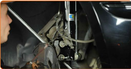
**24** Reinigen Sie das Befestigungselement der Halterung, die den Bremsschlauch mit dem Federbein verbindet. Benutzen Sie eine Drahtbürste. Benutzen Sie WD-40-Spray.
