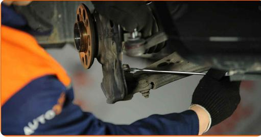
**23** Ziehen Sie den unteren Arm vom Achsschenkel ab. Benutzen Sie ein Brecheisen. Benutzen Sie einen Hammer.
