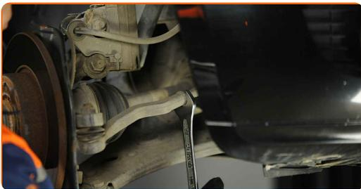
**8** Reinigen Sie das Befestigungselement, das den Spurstangenkopf mit dem Achsschenkel verbindet. Benutzen Sie eine Drahtbürste. Benutzen Sie WD-40-Spray.
