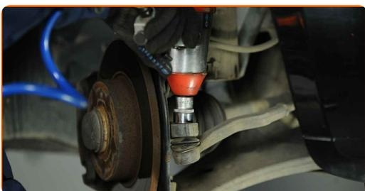
**10** Ziehen Sie den Spurstangenkopf vom Achsschenkel. Verwenden Sie einen Kugelgelenkabzieher.
