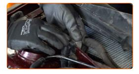
Senken Sie die wasserdichte Isolierung ab.
