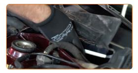
7 Entfernen Sie das Luftfiltergehäuse.
