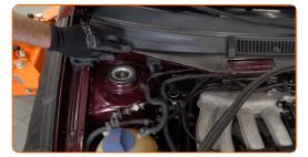
Bringen Sie die obere Verdichtung an der Schutzwand an.
