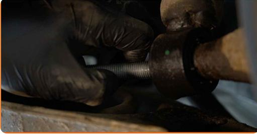
**13** Schrauben Sie das obere Befestigungselement des Stoßdämpfers ab. Verwenden Sie Stecknuss Nr. 16. Verwenden Sie einen Ratschenschlüssel.
