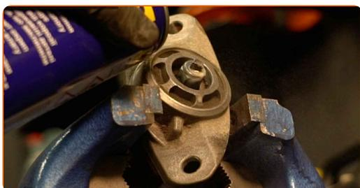
**19** Entfernen Sie die Befestigung der Stoßdämpferkolbenstange. Verwenden Sie einen Stoßdämpfer Steckschlüsseleinsatz DDN#6. Verwenden Sie Stecknuss Nr. 16. Verwenden Sie einen Ratschenschlüssel.
