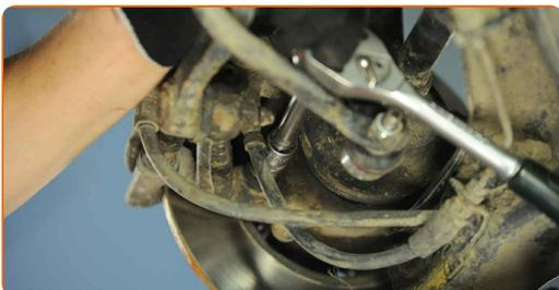
**14** Entfernen Sie die Sattelhalterung.
