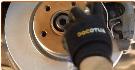
**26** Reinigen Sie die Oberfläche an welcher die Felge montiert werden soll. Benutzen Sie einen Bremsenreiniger.
