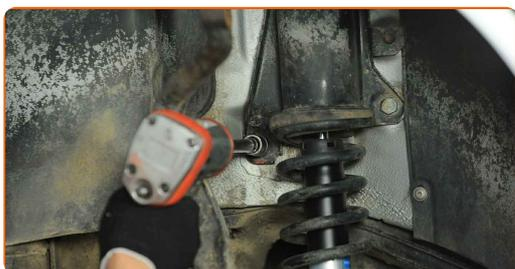
**19** Lösen Sie den unteren Querlenker. Benutzen Sie ein Brecheisen.
