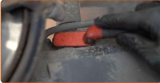
**9** Untere Befestigung der Stoßdämpferfedern abschrauben. Verwenden Sie Ring-Gabelschlüssel Nr. 19. Verwenden Sie Stecknuss Nr. 19. Verwenden Sie einen Ratschenschlüssel.
