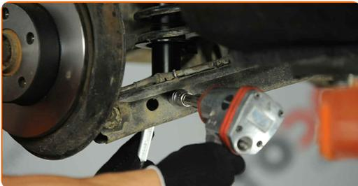
**10** Entfernen Sie die Befestigungsschraube.
