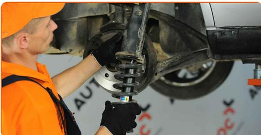
**22** Stellen Sie das Dämpferbein auf das Federspannwerkzeug.
