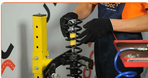
**31** Montieren Sie die obere Stoßdämpferhalterung, die mit den Querlenkern zusammengebaut ist.
