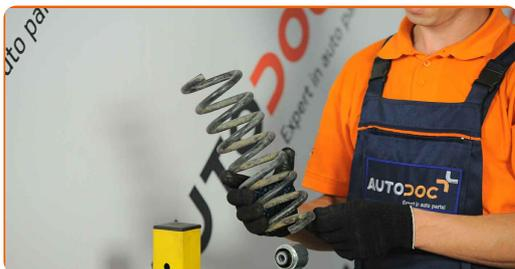
**30** Installieren Sie die Feder am Stoßdämpfer.
