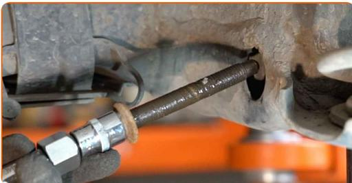
**11** Reinigen Sie alle Verbindungen des Querlenkers. Benutzen Sie eine Drahtbürste. Benutzen Sie WD-40-Spray.
