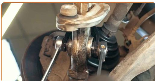
**67** Stützen Sie die Achsschenkel auf. Benutzen Sie einen hydraulischen Getriebeheber.
