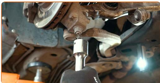
**68** Ziehen Sie die untere Befestigung des Stoßdämpfers an. Verwenden Sie Ring-Gabelschlüssel Nr. 18. Verwenden Sie Stecknuss Nr. 18. Verwenden Sie einen Drehmomentschlüssel. Ziehen Sie ihn mit 90 Nm Drehmoment fest.
