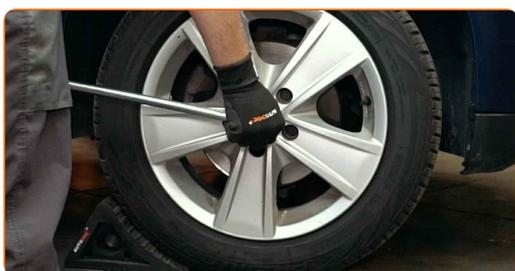
**9** Lösen Sie die Radhalterungsschrauben. Verwenden Sie eine Schlagnuss für Felgen # 17.
