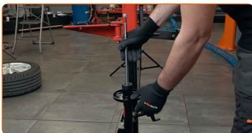
**29** Installieren Sie die Feder am Stoßdämpfer.
