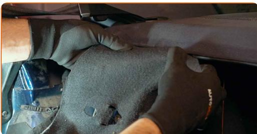
**57** Bauen Sie die Halterung des Seitenverkleidungspanels ein.
