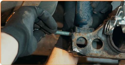
**16** Schrauben Sie das obere Befestigungselement des Federbeins ab.
