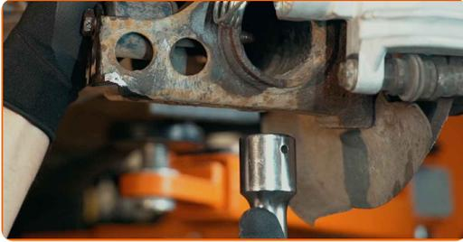
**15** Entfernen Sie die Befestigungsschraube.
