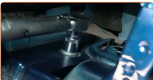
**55** Behandeln Sie die Befestigungselemente des Federbeinstützlagers. Benutzen Sie ein Kupferschmiermittel.
