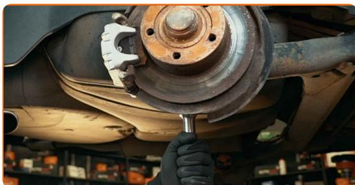
**44** Ziehen Sie die untere Befestigung des Stoßdämpfers an. Verwenden Sie Ring-Gabelschlüssel Nr. 16. Verwenden Sie Stecknuss Nr. 16. Verwenden Sie einen Drehmomentschlüssel. Ziehen Sie ihn mit 50 Nm Drehmoment fest.+90°
