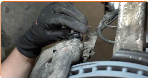
**24** Verbinden Sie den Stecker des Verschleißsensors der Bremsbeläge.
