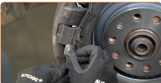
**23** Verbinden Sie den Bremsbelag-Verschleiß-Sensor.
