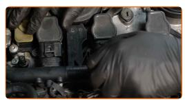
Schraube die Befestigungselemente der Zündspulen-Kabelführung ein. Verwenden Sie den Torx T30. Verwenden Sie einen Ratschenschlüssel.
