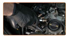
Schrauben Sie die neuen Zündkerzen an und ziehen Sie diese fest. Verwenden Sie die Zündkerzennuss # 16. Verwenden Sie einen Drehmomentschlüssel. Ziehen Sie ihn mit 27 Nm Drehmoment fest.
