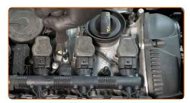
Lösen Sie die Steckverbindung von den Zündspulen.
