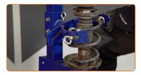
Reinigen Sie die Stoßdämpferstange. Benutzen Sie eine Drahtbürste. Benutzen Sie WD-40-Spray.
