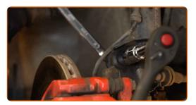
Entfernen Sie den Träger unter dem Achsschenkel.
