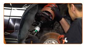
Ziehen Sie die obere Befestigungsmutter des Dämpferbeins heraus. Schrauben Sie diese nicht fest.
