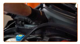
Entfernen Sie die Kotflügel-Abdeckung.
