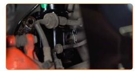
Befestigen Sie das Dämpferbein auf dem Achsschenkel. Die neuen Achsschenkelschrauben einbauen.
