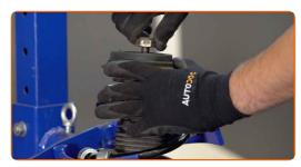
Ziehen Sie die Federbeinkolbenstangenmutter an. Benutzen Sie den Ringschlüssel #27. Verwenden Sie Inbusschlüssel Nr. H7. Verwenden Sie einen Drehmomentschlüssel. Ziehen Sie ihn mit 60 Nm Drehmoment fest.
