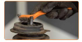
Entfernen Sie die Stangenmutter des Federkolben. Verwenden Sie Ring-Gabelschlüssel Nr. 27. Verwenden Sie Inbusschlüssel Nr. H7.
