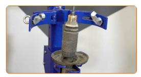
Installieren Sie die Feder am Stoßdämpfer.
