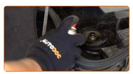
Lösen Sie die obere Befestigung der Federbeinbefestigung. Verwenden Sie Ring-Gabelschlüssel Nr. 19. Verwenden Sie Inbusschlüssel Nr. H7. Verwenden Sie einen Ratschenschlüssel.
