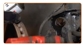
Schrauben Sie die Mutter ab und entfernen Sie die Stabilisatorstange aus dem Federbein. Benutzen Sie den 14 Ringschlüssel #18. Verwenden Sie Stecknuss Nr. 18. Verwenden Sie Inbusschlüssel Nr. H5.
