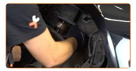
Stellen Sie das Dämpferbein auf das Federspannwerkzeug.
