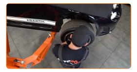
Lösen Sie die Verdrahtung und den Bremsschlauch aus der Halterung am Federbein. Verwenden Sie eine Rundzange.
