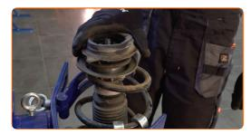
Installieren Sie die obere Halterung, das Federbeinlager und den oberen Federteller. Benutzen Sie ein Brecheisen.
