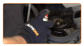
Lösen Sie die obere Befestigung des Domlagers. Verwenden Sie Ring-Gabelschlüssel Nr. 19. Verwenden Sie Inbusschlüssel Nr. H7. Verwenden Sie einen Ratschenschlüssel.
