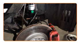
Ziehen Sie die unteren Befestigungen an, die das Federbein mit dem Achsschenkel verbinden. Verwenden Sie Stecknuss Nr. 15. Benutzen Sie den Ringschlüssel #17. Verwenden Sie einen Drehmomentschlüssel. Ziehen Sie ihn mit 85 Nm Drehmoment fest.
