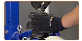
Ziehen Sie die Federbeinkolbenstangenmutter an. Benutzen Sie den Ringschlüssel #27. Verwenden Sie Inbusschlüssel Nr. H7. Verwenden Sie einen Drehmomentschlüssel. Ziehen Sie ihn mit 60 Nm Drehmoment fest.
