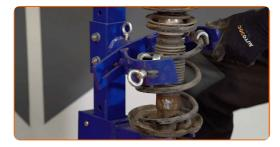
Reinigen Sie die Stoßdämpferstange. Benutzen Sie eine Drahtbürste. Benutzen Sie WD-40-Spray.
