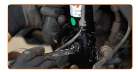
Entfernen Sie den Träger unter dem Achsschenkel.
