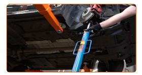
Schrauben Sie das untere Befestigungselement ab, dass das Federbein mit dem Achsschenkel verbindet.
