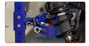
Installieren Sie das Federbein am Radlauf. Ziehen Sie die obere Befestigungsmutter des Dämpferbeins heraus. Schrauben Sie diese nicht fest.
