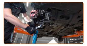
Schließen Sie das Befestigungslement des ABS-Sensorkabels an die Stoßdämpferstrebe an. Befestigen Sie den Bremsschlauch an der Strebe.
