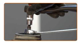
Entfernen Sie die obere Halterung, die Stützlager und den oberen Federteller.
