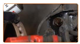
Schrauben Sie die Mutter ab und entfernen Sie die Stabilisatorstange aus dem Federbein. Benutzen Sie den Ringschlüssel #18. Verwenden Sie Stecknuss Nr. 18. Verwenden Sie Inbusschlüssel Nr. H5.
