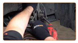
Schrauben Sie die untere Befestigung der Stoßdämpferstrebe ab.
