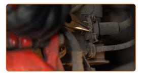
Reinigen Sie die Befestigungselemente, welche den Stabilenker mit dem Federbein verbinden, sowie die, welche das Federbein mit dem Achsschenkel verbinden.
