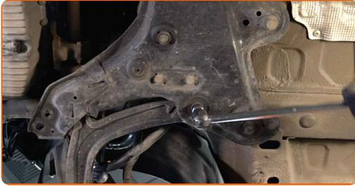
**31** Setzen Sie das Verbindungselement, welches das Kugelegelenk mit dem Achsschenkel verbindet, frei. Verwenden Sie einen flachen Metallmeißel. Benutzen Sie einen Hammer.
