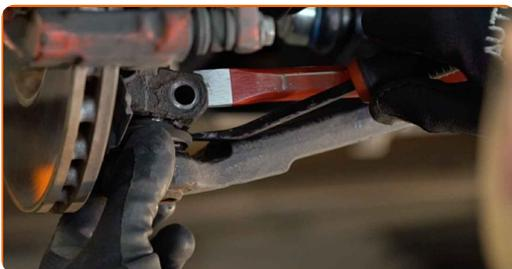
**32** Trennen Sie das Kugelgelenk vom Achsschenkel. Benutzen Sie ein Brecheisen.
