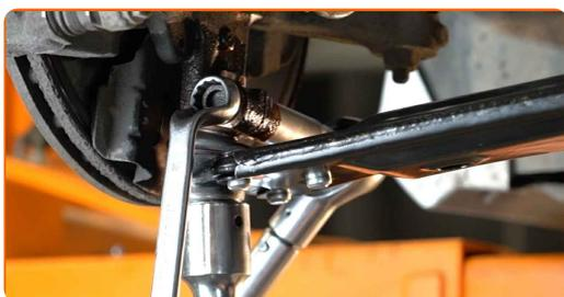
**27** Entfernen Sie den Träger unter dem Arm.
