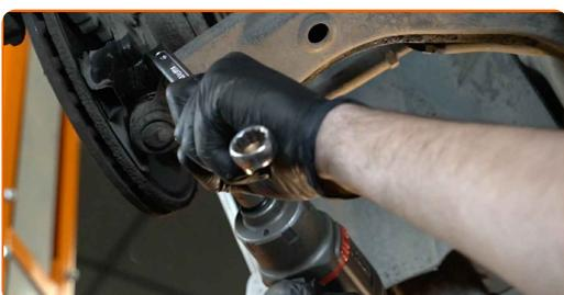
**8** Entfernen Sie die Befestigungsschraube.
