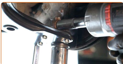
**23** Schrauben Sie das hintere Befestigungselement ein, das den Querlenker mit dem Hilfsrahmen verbindet. Verwenden Sie Ring-Gabelschlüssel Nr. 18. Verwenden Sie Stecknuss Nr. E18. Verwenden Sie einen Ratschenschlüssel.
