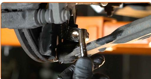
**9** Schrauben Sie die vordere Armbefestigung ab. Verwenden Sie Stecknuss Nr. E18. Verwenden Sie ein Windeisen.
