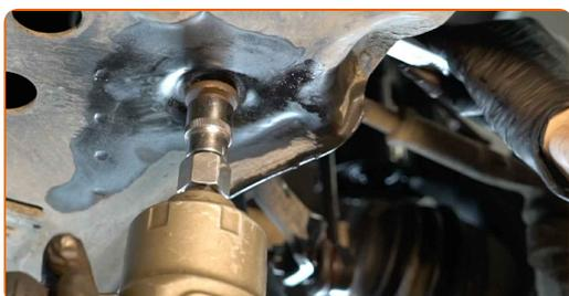
**24** Ziehen Sie das vordere Befestigungselement an, das den Querlenker mit dem Hilfsrahmen verbindet. Verwenden Sie Stecknuss Nr. E18. Verwenden Sie einen Drehmomentschlüssel. Ziehen Sie ihn mit 60 Nm Drehmoment fest.+90°
