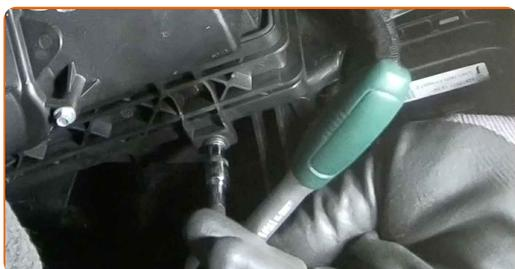
**6** Entfernen Sie die Kabinenfilterabdeckung.
