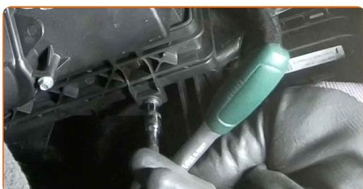
**6** Entfernen Sie die Kabinenfilterabdeckung.
