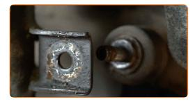
Reinigen Sie das Befestigungselement, das das Federbein mit dem Achsschenkel verbindet. Reinigen Sie die Befestigungen des Querlenkers. Benutzen Sie eine Drahtbürste. Benutzen Sie WD-40-Spray.
