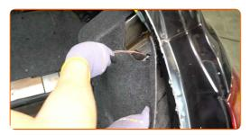
Schrauben Sie das Befestigungselement der Seitenauskleidung des Kofferraums ein. Verwenden Sie einen Kreuzschlitzschraubendreher.
