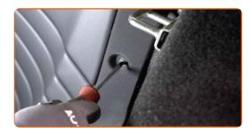
Entfernen Sie die Seitenabdeckung aus Kunststoff.
