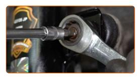
Ziehen Sie das Befestigungselement an, das die Druckstange mit dem Federbein verbindet. Verwenden Sie Stecknuss Nr. 17. Verwenden Sie einen Drehmomentschlüssel. Ziehen Sie ihn mit 55 Nm Drehmoment fest.
