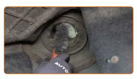
Installieren Sie das Federbein am Radlauf.
