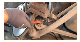
Schrauben Sie die Befestigung, die das Federbein mit dem hinteren Achsschenkel verbindet, ab. Verwenden Sie Ring-Gabelschlüssel Nr. 19. Verwenden Sie Stecknuss Nr. 19. Verwenden Sie einen Ratschenschlüssel.
