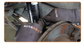
Den Halteclip des Bremsschlauchs anbringen. Benutzen Sie ein Brecheisen.
