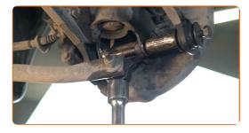
Entfernen Sie die Befestigungsschrauben.
