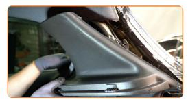
Reinigen Sie die obere Befestigung des Federbeinlagers. Benutzen Sie WD-40-Spray.
