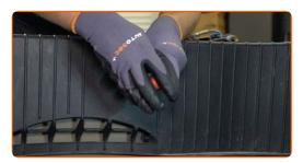
Ziehen Sie die Haken fest, die die Kofferraumverkleidung festhalten. Verwenden Sie Inbusschlüssel Nr. H5. Verwenden Sie einen Ratschenschlüssel.
