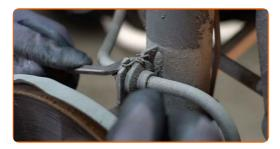
Lösen Sie den Bremsschlauch vom Federbein.
