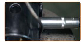
Ziehen Sie das Befestigungselement an, das den Achslenker mit dem Achsschenkel verbindet. Verwenden Sie Ring-Gabelschlüssel Nr. 19. Verwenden Sie Stecknuss Nr. 19. Verwenden Sie einen Drehmomentschlüssel. Ziehen Sie ihn mit 115 Nm Drehmoment fest.
