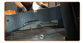
8 Entfernen Sie die Kofferraumverkleidung.
