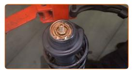
Entfernen Sie das zusammengebaute Federbein.
