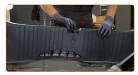
Schrauben Sie das Befestigungselement der zentralen Schutzverkleidung aus Kunststoff ein. Verwenden Sie einen Kreuzschlitzschraubendreher.
