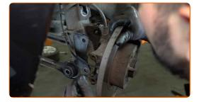
Entfernen Sie das zusammengebaute Federbein. Benutzen Sie ein Brecheisen.
