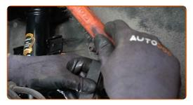
Montieren Sie den Querlenker.
