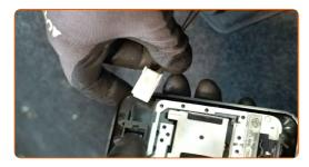
Schrauben Sie das Befestigungselement der Seitenauskleidung des Kofferraums heraus. Verwenden Sie einen Kreuzschlitzschraubendreher.
