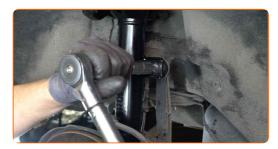
Befestigen Sie den Bremsschlauch an der Strebe.
