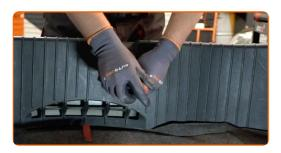
Lösen Sie die Haken, die die Kofferraumverkleidung festhalten. Verwenden Sie Inbusschlüssel Nr. H5. Verwenden Sie einen Ratschenschlüssel.
