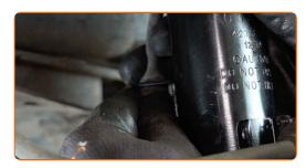
Behandeln Sie die Federbein-Befestigungen. Behandeln Sie alle Gelenke der Koppelstange. Behandeln Sie die Befestigungen des hinteren Achsschenkels. Benutzen Sie ein Kupferschmiermittel.
