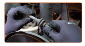
Trennen Sie die ABS Sensorverdrahtung.
