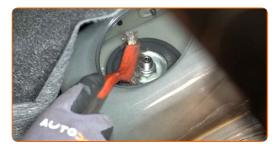
Lösen Sie die oberen Befestigungselemente des Federbeinstützlagers. Verwenden Sie Inbusschlüssel Nr. H6. Verwenden Sie Stecknuss Nr. 22. Verwenden Sie einen Ratschenschlüssel.
