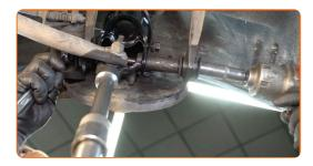
Schrauben Sie die Befestigung an, die den Stoßdämpfer mit dem hinteren Achsschenkel verbindet. Verwenden Sie Ring-Gabelschlüssel Nr. 19. Verwenden Sie Stecknuss Nr. 19. Verwenden Sie einen Ratschenschlüssel.
