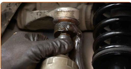
**17** Lösen Sie den Querlenker. Verwenden Sie einen Kugelgelenkabzieher.
