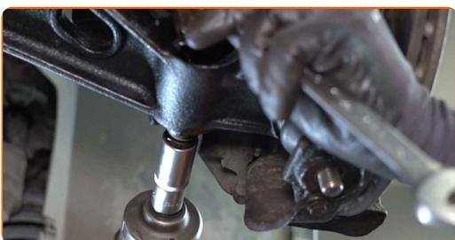
**38** Verbinden Sie das Kugelgelenk mit dem Achsschenkel.
