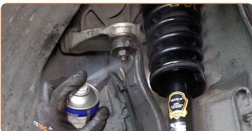
**16** Schrauben Sie das Befestigungselement ab, das den Achslenker mit dem Achsschenkel verbindet. Verwenden Sie Stecknuss Nr. 17. Verwenden Sie einen Ratschenschlüssel.
