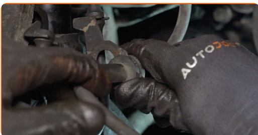
**47** Den Halteclip des Bremsschlauchs anbringen.
