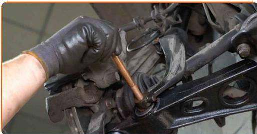
**37** Schrauben Sie das Befestigungselement ein, das die Stoßdämpfergabel mit dem unteren Querlenker verbindet. Verwenden Sie Ring-Gabelschlüssel Nr. 19. Verwenden Sie Stecknuss Nr. 19. Verwenden Sie einen Ratschenschlüssel.
