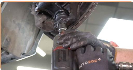
**40** Ziehen Sie das Befestigungselement fest, das das Traggelenk mit dem Achsschenkel verbindet. Verwenden Sie Stecknuss Nr. 24. Verwenden Sie einen Drehmomentschlüssel. Ziehen Sie ihn mit 90 Nm Drehmoment fest.
