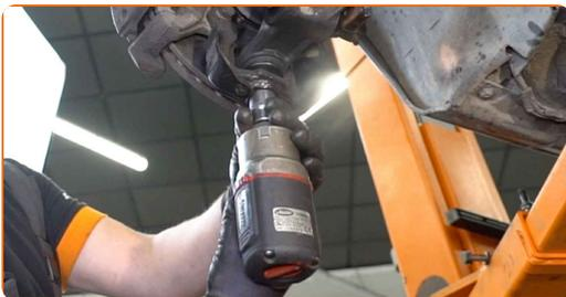
**13** Trennen Sie das Kugelgelenk vom Achsschenkel. Verwenden Sie einen Kugelgelenkabzieher.
