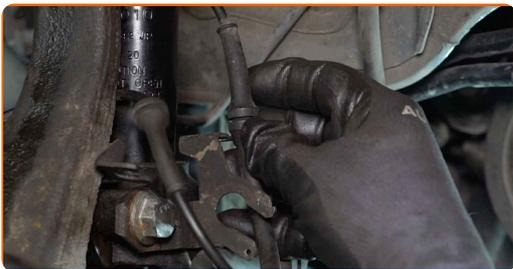
**46** Befestigen Sie den Bremsschlauch an der Strebe.
