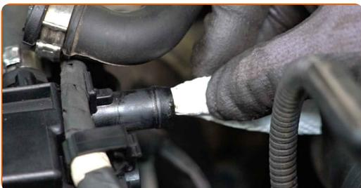
**20** Lösen Sie den Steckverbinder des Luftmassenmessers.
