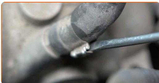
**29** Lösen Sie den Kühlmittelschlauch.
