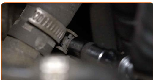
**31** Lösen Sie den Kühlmittelschlauch.
