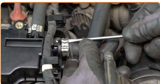
**19** Decken Sie das PCV-Ventilloch mit einem Mikrofasertuch ab, um zu verhindern, dass Schmutz und Fremdkörper in das System gelangen.
