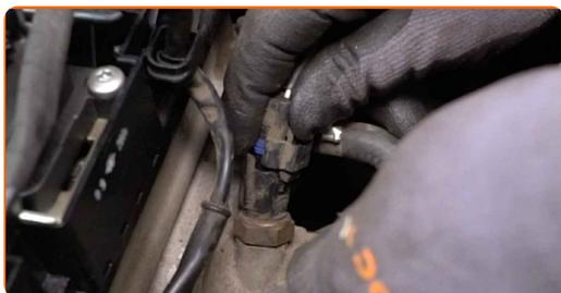
**28** Lockern Sie die Klemme des Kühlmittelschlauchs. Verwenden Sie einen flachen Schraubendreher.
