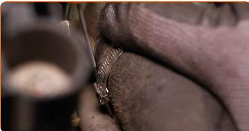
**33** Lösen Sie den Kühlmittelschlauch.
