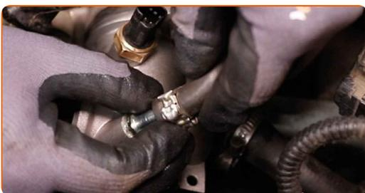
**45** Sichern Sie die Klemme des Kühlmittelschlauchs. Verwenden Sie eine Clic-R-Kragenzange.
