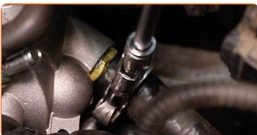
**44** Bringen Sie den Kühlmittelschlauch an.
