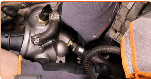
**43** Sichern Sie die Klemme des Kühlmittelschlauchs. Verwenden Sie Stecknuss Nr. 7. Verwenden Sie einen Ratschenschlüssel.
