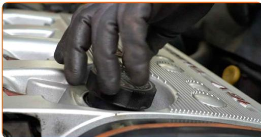
**14** Entfernen Sie die Öleinfüllschraube.
