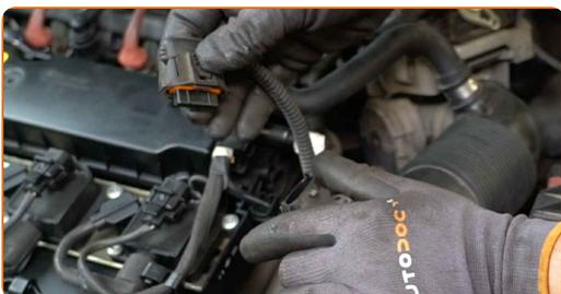
**21** Ziehen Sie den Stecker des Luftmassenmessers ab. Verwenden Sie einen flachen Schraubendreher.
