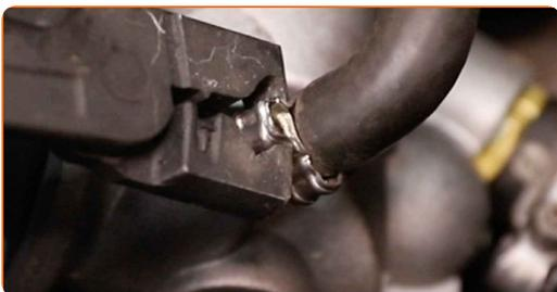
**46** Bringen Sie den Kühlmittelschlauch an.
