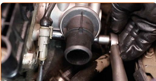
**42** Bringen Sie den Kühlmittelschlauch an.
