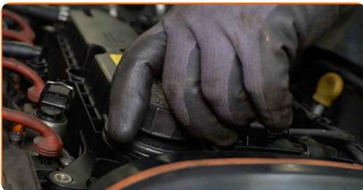
**18** Lösen Sie auf der rechten Seite den Schlauch des PCV-Ventils von der Motorabdeckung. Verwenden Sie einen flachen Schraubendreher.
