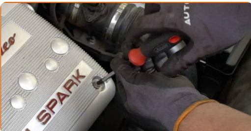
**13** Schrauben Sie die Öleinfüllschraube ab.
