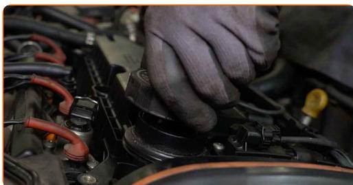
**17** Befestigen Sie den Deckel des Öleinfüllstutzens.
