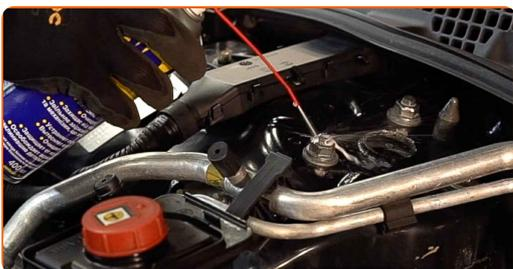
**4** Lösen Sie die oberen Befestigungselemente des Federbeinstützlagers. Verwenden Sie Stecknuss Nr. 16. Verwenden Sie einen Ratschenschlüssel.
