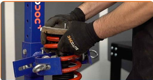
**34** Ziehen Sie die Federbeinkolbenstangenmutter an. Verwenden Sie Ring-Gabelschlüssel Nr. 6. Verwenden Sie Ring-Gabelschlüssel Nr. 18. Verwenden Sie Stecknuss Nr. 18. Verwenden Sie einen Drehmomentschlüssel. Ziehen Sie ihn mit 33 Nm Drehmoment fest.
