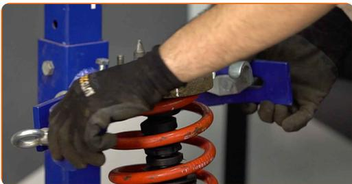
**36** Entfernen Sie das zusammengebaute Federbein.
