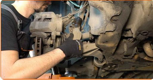
**18** Lösen Sie die obere Befestigung der Federbeinbefestigung.
