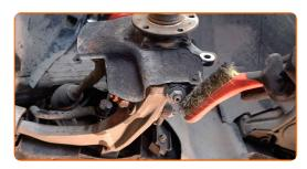
Schrauben Sie die Kugelgelenkbefestigung vom Achsschenkel ab. Verwenden Sie Stecknuss Nr. 21. Verwenden Sie ein Windeisen.
