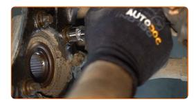
Entfernen Sie die Nabe und das Lager zusammen, da sie eine versiegelte Einheit sind. Benutzen Sie ein Brecheisen.
