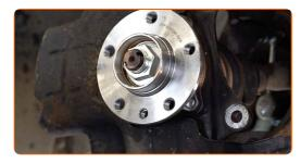
Behandeln Sie die Radnabe an der Kontaktstelle mit der Bremsscheibe. Benutzen Sie ein Kupferschmiermittel.
