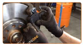
Installieren Sie den Bremssattel und fixieren Sie diesen. Verwenden Sie Inbusschlüssel Nr. H7. Verwenden Sie einen Drehmomentschlüssel. Ziehen Sie ihn mit 30 Nm Drehmoment fest.
