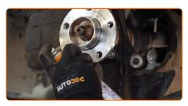
Schrauben Sie die Nabenkontermutter des Rads an.
