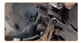
Entfernen Sie den Träger unter dem Achsschenkel.
