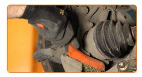
Lösen Sie die Befestigung der Sattelhalterung. Verwenden Sie Stecknuss Nr. 19. Verwenden Sie ein Windeisen. Verwenden Sie einen Ratschenschlüssel.
