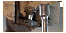
Entfernen Sie den Träger unter dem Arm.
