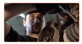
16 Entfernen Sie die Sattelhalterung.
