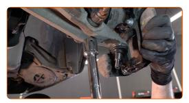
Verbinden Sie das Kugelgelenk mit dem Achsschenkel. Verbinden Sie den Unterarm mit dem Achsschenkel.
