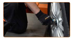
Entfernen Sie die Schutzkappe des Nabenlagers. Verwenden Sie einen flachen Schraubendreher.
