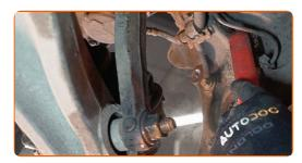
Schrauben Sie die Radnaben-Achsmutter ab. Verwenden Sie Stecknuss Nr. E14. Verwenden Sie einen Ratschenschlüssel. Verwenden Sie ein Windeisen.
