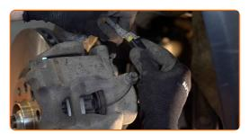
Installieren Sie die Staubschutzkappen der Bremssattel-Führungsstifte.
