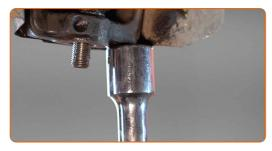
Ziehen Sie das Kugelgelenk an. Verwenden Sie Stecknuss Nr. 21. Verwenden Sie einen Drehmomentschlüssel. Ziehen Sie ihn mit 81 Nm Drehmoment fest.
