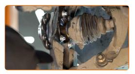
Reinigen Sie den Kugelgelenk-Montagesitz. Benutzen Sie eine Drahtbürste. Benutzen Sie WD-40-Spray.
