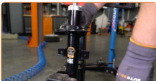
**45** Installieren Sie die Staubschutzmanschette und den Anschlagpuffer auf dem neuen Stoßdämpfer.
