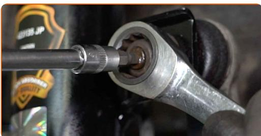
**66** Ziehen Sie das Befestigungselement an, das die Druckstange mit dem Federbein verbindet. Verwenden Sie Stecknuss Nr. 17. Verwenden Sie einen Drehmomentschlüssel. Ziehen Sie ihn mit 55 Nm Drehmoment fest.
