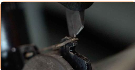
**69** Verbinden Sie das ABS mit der Sensorverdrahtung.
