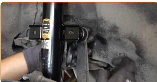
**65** Ziehen Sie die Befestigungselemente des Stabilenkers fest. Verwenden Sie Ring-Gabelschlüssel Nr. 17. Verwenden Sie Inbusschlüssel Nr. H5. Verwenden Sie einen Ratschenschlüssel.
