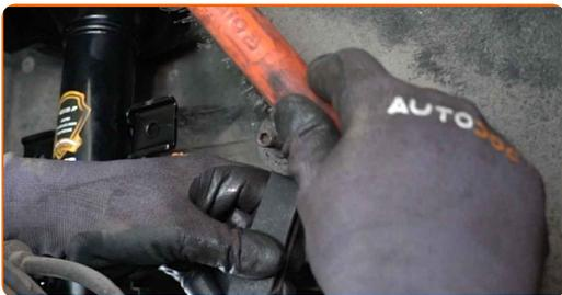
**64** Montieren Sie den Querlenker.
