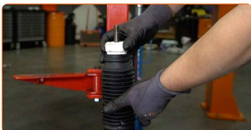
**46** Installieren Sie die Feder am Stoßdämpfer.
