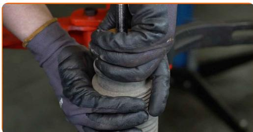
**43** Entnehmen Sie den alten Stoßdämpfer aus dem hydraulischen Spiralfederspanner.
