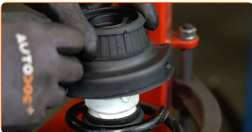
**49** Ziehen Sie die Federbeinkolbenstangenmutter an. Verwenden Sie Stecknuss Nr. 22. Verwenden Sie Inbusschlüssel Nr. H6. Verwenden Sie einen Drehmomentschlüssel. Ziehen Sie ihn mit 65 Nm Drehmoment fest.
