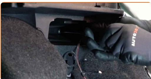
**13** Trennen Sie die Seitenauskleidung des Kofferraums heraus. Verwenden Sie einen Zierleistenkeil.
