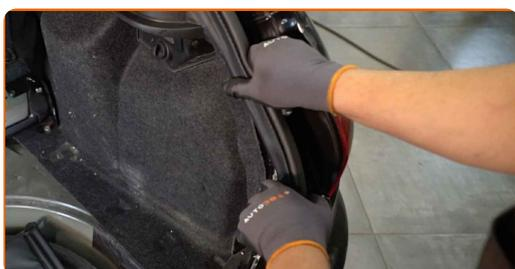
**10** Entfernen Sie die Kofferrauminnenbeleuchtung. Verwenden Sie einen Zierleistenkeil.
