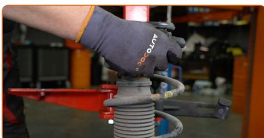
**42** Die Staubkappe des Stoßdämpfers und den Anschlagpuffer entfernen.
