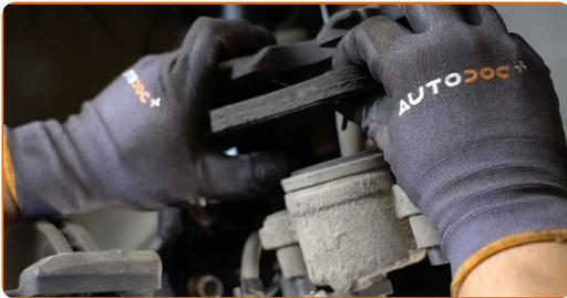
**Austausch: Bremsbeläge – Opel Astra H Limousine. Tipp von AUTODOC:**
