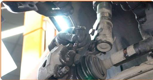
**Austausch: Bremsschläuche – AUDI 100 C3 Avant (44, 44Q). AUTODOC-Experten empfehlen:**
