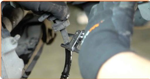
**16** Schrauben Sie den Bremsschlauch vom Bremssattel ab.
