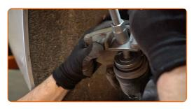
Entfernen Sie die Bremsbeläge.
