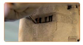
11 Entfernen Sie den Bremssattel.
