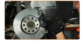
27.1 Installieren Sie den Bremssattel und fixieren Sie diesen.
