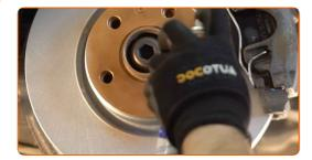
Die Bremsscheibenoberfläche reinigen. Benutzen Sie einen Bremsenreiniger.
