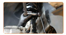
Ziehen Sie das Befestigungselement an, das die Druckstange mit dem Stabilisator verbindet. Verwenden Sie Stecknuss Nr. 17. Verwenden Sie einen Drehmomentschlüssel. Ziehen Sie ihn mit 40 Nm Drehmoment fest.
