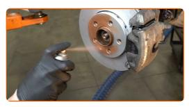
Die Bremsscheibenoberfläche reinigen. Benutzen Sie einen Bremsenreiniger.
