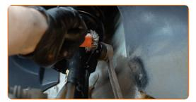
Schrauben Sie das Befestigungselement heraus, das die Druckstange mit dem Stabilisator verbindet. Verwenden Sie Stecknuss Nr. 16. Verwenden Sie einen Ratschenschlüssel.
