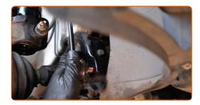
Ziehen Sie das Befestigungselement an, das die Druckstange mit dem Federbein verbindet. Verwenden Sie Stecknuss Nr. 17. Verwenden Sie einen Drehmomentschlüssel. Ziehen Sie ihn mit 40 Nm Drehmoment fest.
