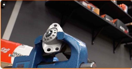
**20** Schrauben Sie die untere Befestigung der Federbeinkolbenstange an. Verwenden Sie Ring-Gabelschlüssel Nr. 17. Benutzen Sie einen Rollgabelschlüssel. Verwenden Sie einen Drehmomentschlüssel. Ziehen Sie ihn mit 25 Nm Drehmoment fest.
