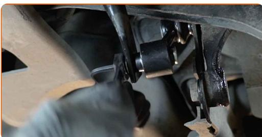
**13** Ziehen Sie das Befestigungselement an, das den Stabilisator mit dem Querlenker verbindet. Verwenden Sie Stecknuss Nr. 14. Verwenden Sie einen Drehmomentschlüssel. Ziehen Sie ihn mit 45 Nm Drehmoment fest.
