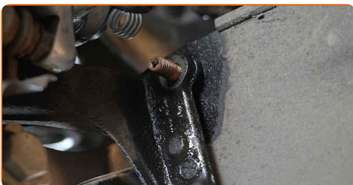
**12** Ziehen Sie die Befestigungselemente des Stabilenkers fest. Verwenden Sie Ring-Gabelschlüssel Nr. 14. Verwenden Sie Inbusschlüssel Nr. H5. Verwenden Sie einen Ratschenschlüssel.
