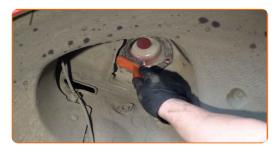
Installieren Sie das Federbein am Radlauf.
