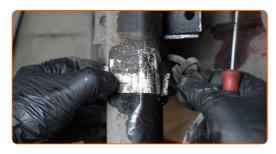
Trennen Sie den Bremsschlauch. Benutzen Sie ein Brecheisen.
