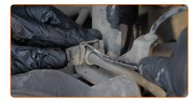
Trennen Sie die ABS Sensorverdrahtung.
