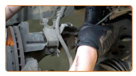
Lösen Sie die obere Befestigung der Federbeinbefestigung.
