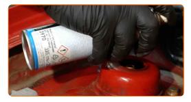
Setzen Sie die Schutzkappe auf die Stoßdämpferstütze.
