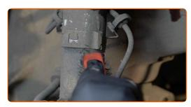
Behandeln Sie die Halteklammer des Bremsschlauchs.
