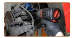
Ziehen Sie die unteren Befestigungen an, die das Federbein mit dem Achsschenkel verbinden. Verwenden Sie Stecknuss Nr. 18. Verwenden Sie einen Drehmomentschlüssel. Ziehen Sie ihn mit 60 Nm Drehmoment fest.+90°
