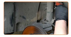
Schrauben Sie das Befestigungselement heraus, das die Druckstange mit dem Federbein verbindet. Verwenden Sie Stecknuss Nr. 17. Verwenden Sie einen Ratschenschlüssel.
