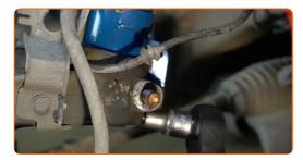
Entfernen Sie den Träger unter dem Achsschenkel.
