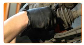
Lösen Sie das Befestigungselement, welches das Kugelgelenk am Federungsquerlenker befestigt. Verwenden Sie Stecknuss Nr. 13. Verwenden Sie ein Windeisen.
