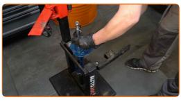
Installieren Sie die Feder am Stoßdämpfer.
