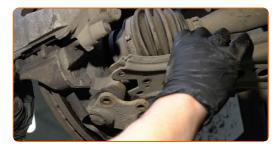
Schrauben Sie die Befestigungen des Kugelgelenks ein. Verwenden Sie Stecknuss Nr. 13. Verwenden Sie einen Ratschenschlüssel.
