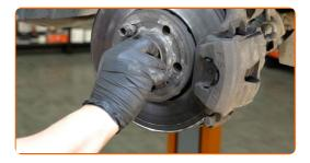
Die Antriebswellenmutter festziehen. Verwenden Sie Stecknuss Nr. 36. Verwenden Sie einen Drehmomentschlüssel. Ziehen Sie ihn mit 50 Nm Drehmoment fest.+45°
