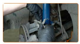
Verbinden Sie das ABS mit der Sensorverdrahtung. Verwenden Sie eine Wasserpumpenzange.
