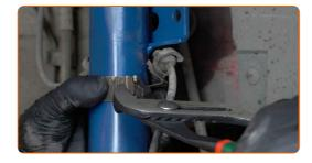
68 Montieren Sie den Querlenker.
