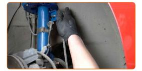
Ziehen Sie das Befestigungselement an, das die Druckstange mit dem Federbein verbindet. Verwenden Sie Stecknuss Nr. 17. Verwenden Sie einen Drehmomentschlüssel. Ziehen Sie ihn mit 40 Nm Drehmoment fest.
