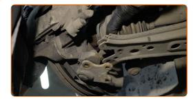
Verbinden Sie das Kugelgelenk mit dem Lenker.
