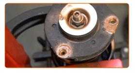
Dekomprimieren Sie die Feder.
