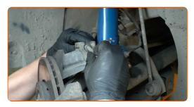
Bringen Sie die Halteklammer des Bremsschlauchs an.
