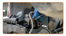
Befestigen Sie das Dämpferbein auf dem Achsschenkel.
