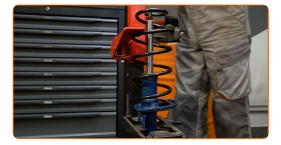
Montieren Sie die Befestigung, die Manschette und den Stoßstopp am neuen Stoßdämpfer.
