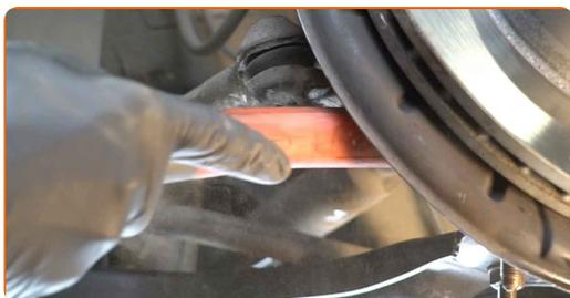
**7** Lösen Sie das Ende der Befestigungsmutter an dem Achsschenkel. Verwenden Sie Stecknuss Nr. 18. Verwenden Sie ein Windeisen.
