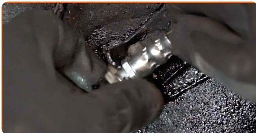
**19** Befestigen Sie den neuen Bremsschlauch.
