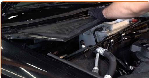
**4** Verwenden Sie eine Kotflügel-Schutzabdeckung, um Schäden an der Lackierung und den Kunststoffteilen des Autos zu verhindern.
