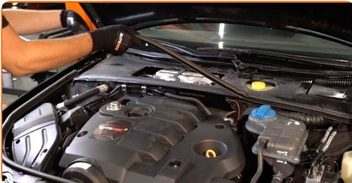
**3** Heben Sie die Windabweiserabdeckung an und entfernen Sie dieses.
