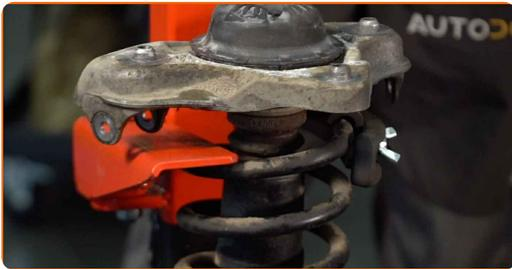
**37** Entfernen Sie die Stangenmutter des Federkolben. Verwenden Sie Inbusschlüssel Nr. H6. Verwenden Sie Stecknuss Nr. 16. Verwenden Sie einen Ratschenschlüssel.
