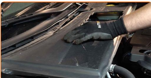
**83** Bauen Sie die Dichtung der Windabweiserabdeckung ein.
