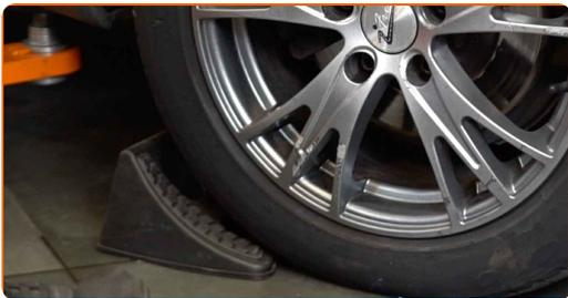
**8** Lösen Sie die Radhalterungsschrauben. Verwenden Sie eine Schlagnuss für Felgen # 17.
