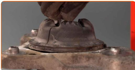
**46** Ziehen Sie die Federbeinkolbenstangenmutter an. Verwenden Sie Inbusschlüssel Nr. H6. Verwenden Sie Stecknuss Nr. 16. Verwenden Sie einen Drehmomentschlüssel. Ziehen Sie ihn mit 50 Nm Drehmoment fest.
