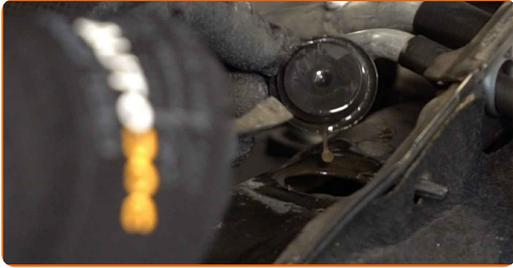
**6** Lösen Sie die obere Befestigung des Domlagers. Verwenden Sie Stecknuss Nr. 16. Verwenden Sie einen Ratschenschlüssel.
