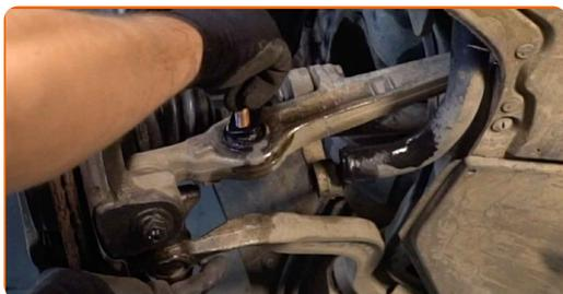
**60** Schrauben Sie das untere Befestigungselement des Federbeins ein. Verwenden Sie Ring-Gabelschlüssel Nr. 18. Verwenden Sie Stecknuss Nr. 18. Verwenden Sie einen Ratschenschlüssel.
