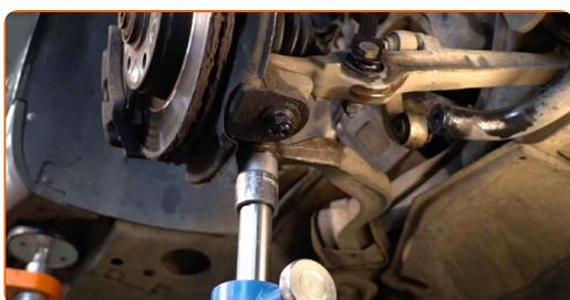
**62** Behandeln Sie alle Gelenke des Querlenkers. Verwenden Sie Mehrzweckfett. Verwenden Sie einen flachen Schraubendreher.
