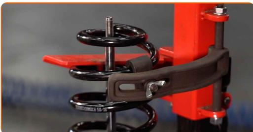
**44** Bringen Sie das Stützlager, die Manschette und den Anschlagpuffer auf dem Stoßdämpfer an.
