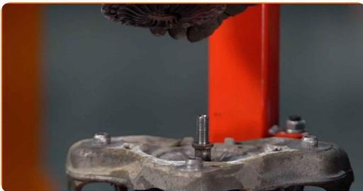
**39** Entfernen Sie die Stoßdämpferhalterung, die Manschette und den Stoßstopp.
