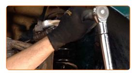
Entfernen Sie den Träger unter dem Arm.
