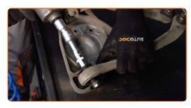
Entfernen Sie die Befestigungsschraube.
