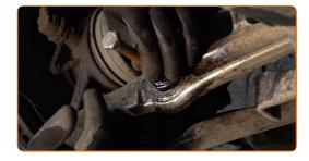
Schrauben Sie das untere Befestigungselement des Federbeins ein. Verwenden Sie Ring-Gabelschlüssel Nr. 18. Verwenden Sie Stecknuss Nr. 18.
