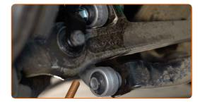
Ziehen Sie das Befestigungselement an, das den Stabilisator mit dem Querlenker verbindet. Verwenden Sie Ring-Gabelschlüssel Nr. 16. Verwenden Sie Stecknuss Nr. 16. Verwenden Sie einen Drehmomentschlüssel. Ziehen Sie ihn mit 40 Nm Drehmoment fest.+90°
