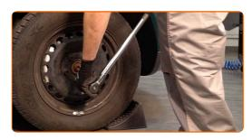
Entfernen Sie den Wagenheber sowie die Unterlegkeile.
