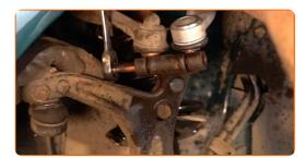
Drehen Sie die Befestigungen (2 Stück) des oberen Querlenkers ein. Verwenden Sie Ring-Gabelschlüssel Nr. 16. Verwenden Sie Stecknuss Nr. 16.
