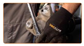
Installieren Sie das Federbein am Radlauf.
