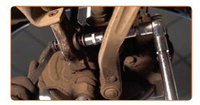
Ziehen Sie die oberen Befestigungsschrauben an (2 Stück). Verwenden Sie Ring-Gabelschlüssel Nr. 16. Verwenden Sie Stecknuss Nr. 16. Verwenden Sie einen Drehmomentschlüssel. Ziehen Sie ihn mit 40 Nm Drehmoment fest.
