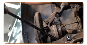
Lösen Sie die obere Befestigung des Domlagers.
