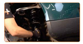
Schrauben Sie die obere Befestigung des Domlagers an. Verwenden Sie Stecknuss Nr. 15. Schrauben Sie diese nicht fest.
