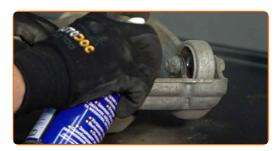
Lösen Sie die Befestigungen, die die Querlenker mit der Federbeinaufnahme verbinden. Verwenden Sie Stecknuss Nr. 16. Verwenden Sie Ring-Gabelschlüssel Nr. 16.
