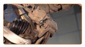
Trennen Sie den Bremsbelag Verschleißsensor. Benutzen Sie ein Brecheisen.
