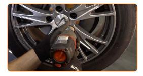
Senken Sie das Auto und ziehen Sie die Radschrauben über Kreuz an. Verwenden Sie einen Drehmomentschlüssel. Ziehen Sie ihn mit 120 Nm Drehmoment fest.
