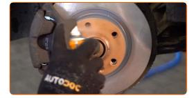
Die Bremsscheibenoberfläche reinigen. Benutzen Sie einen Bremsenreiniger.
