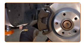
Verbinden Sie den Bremsbelag-Verschleiß-Sensor.
