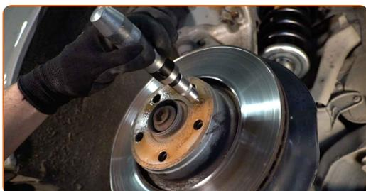
**15** Entfernen Sie die Bremsscheibe.
