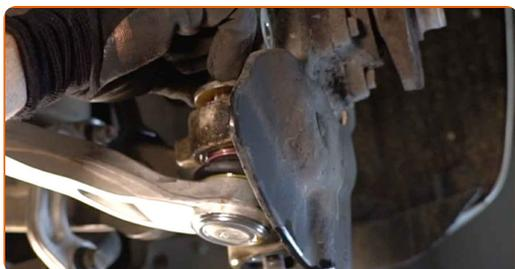
**19** Trennen Sie das Kugelgelenk vom Achsschenkel. Verwenden Sie einen Kugelgelenkabzieher.
