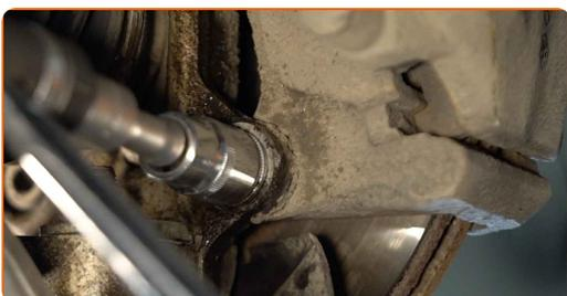
**12** Entfernen Sie die Sattelhalterung.
