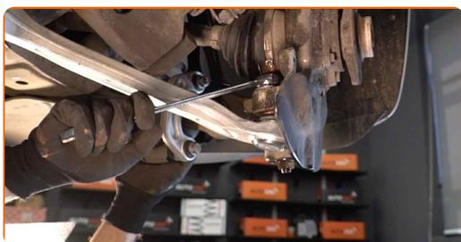
**18** Entfernen Sie die Befestigungsschraube.
