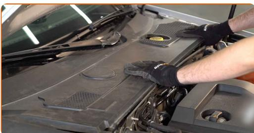
**72** Bauen Sie die Dichtung der Windabweiserabdeckung ein.
