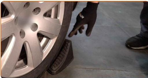
**75** Entfernen Sie die Kotflügel-Abdeckung.
