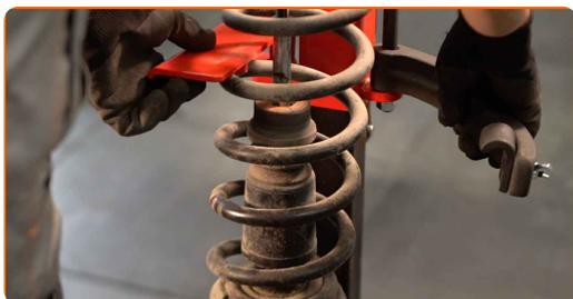
**35** Entfernen Sie die Feder. Die Staubkappe des Stoßdämpfers und den Anschlagpuffer entfernen.
