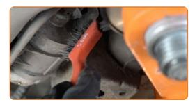
Drücken Sie die Clips zusammen und lösen Sie die Kraftstoffzufuhrleitungen vom Kraftstofffiltergehäuse.
