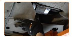
Ziehen Sie die Befestigungen der Kraftstofffilter-Abdeckung an. Verwenden Sie Stecknuss Nr. 10. Verwenden Sie einen Ratschenschlüssel.
