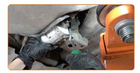
Entfernen Sie den Kraftstofffilter. Legen Sie die alte Filterpatrone in den Behälter.
