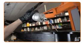
Reinigen Sie die Befestigungen der Kraftstoff-Zuleitungen. Verwenden Sie Allzweckreinigungsspray.
