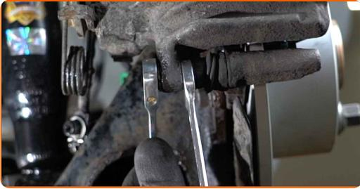
**14** Entfernen Sie den Bremssattel.
