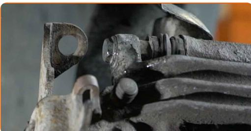
**13** Schrauben Sie die Befestigung des Bremssattels ab. Verwenden Sie Ring-Gabelschlüssel Nr. 13. Verwenden Sie Ring-Gabelschlüssel Nr. 15. Verwenden Sie Stecknuss Nr. 13. Verwenden Sie einen Ratschenschlüssel.
