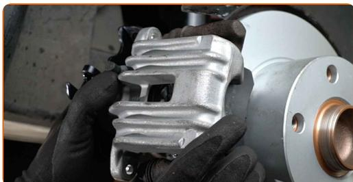
**18** Behandeln Sie den Bremsschlauch. Benutzen Sie einen Bremsenreiniger.
