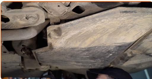
**29** Ziehen Sie die Befestigungsschrauben der Schutzabdeckung fest. Verwenden Sie einen flachen Schraubendreher.
